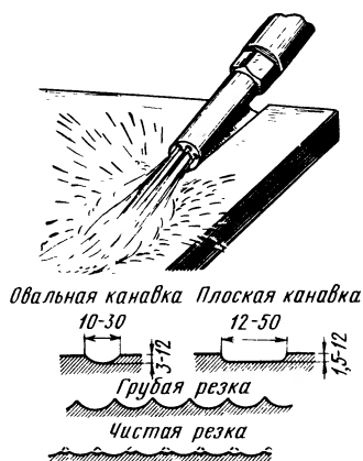
Рис. 68. Поверхностная кислородная резка и формы выплавляемых канавок
