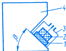
Рис. 149. Наклонный искатель:
